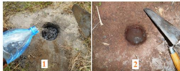
Photos 1 et 2 : tests d'infiltromètre à Mayanga et à Mansimou (Madibou)
